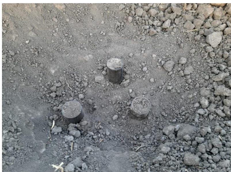
شکل ۲. آرایش مثلثی استوانه‌های نمونه‌برداری از لایه فشرده زیرین در منطقه مطالعاتی
