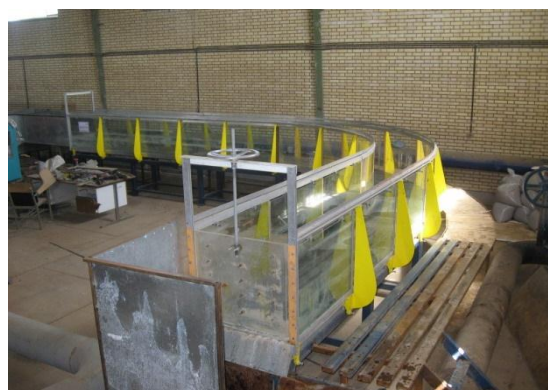
شکل ۳: فلوم قوسی مورد استفاده جهت مدل‌سازی‌ها
