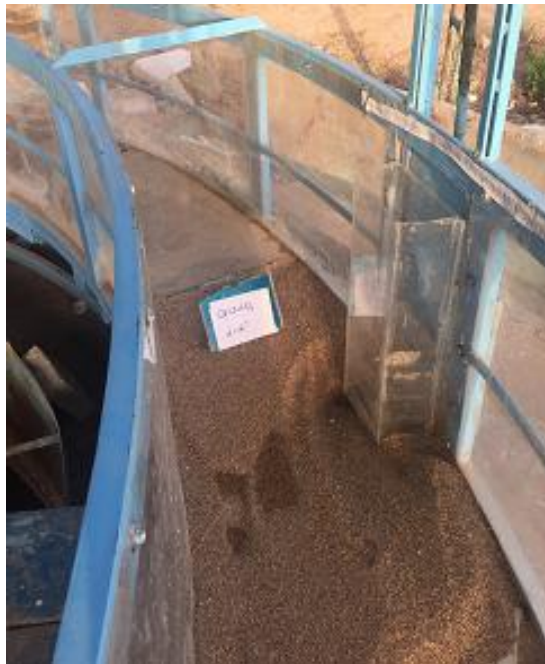
شکل ۲: آبشستگی در اطراف تکیه‌گاه
