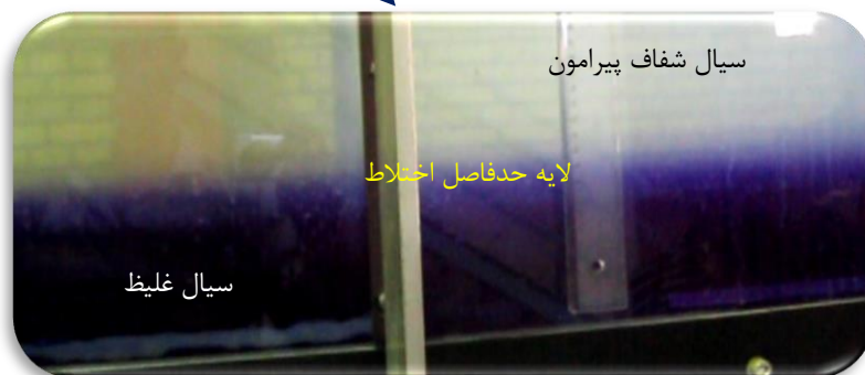
شکل ۲- شرایط قرار گیری لایه‌های با غلظت متفاوت در بدنه و جزئیات آن
