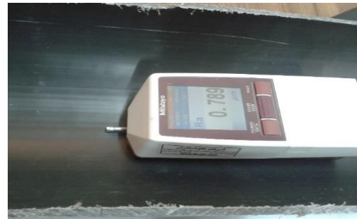
شکل ۱۰- قرائت سطح داخلی نمونه لوله پولیکا (U-PVC) با قطر ۱۲۰ میلی‌متر با استفاده از دستگاه تست کننده زبری سطح و پروفیل تهیه شده از قرائت سطح داخلی نمونه لوله پولیکا (U-PVC).
