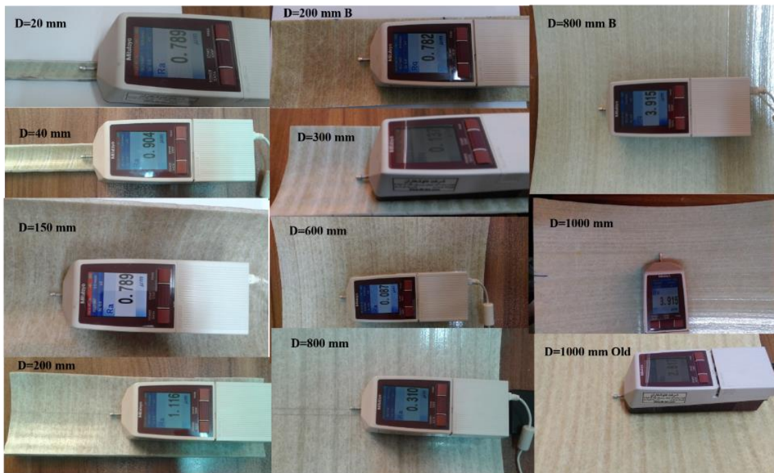
شکل ۷- قرائت سطح داخلی نمونه لوله فایبرگلاس (GRP) با قطرهای ۲۰، ۴۰، ۱۵۰، ۲۰۰ B، ۳۰۰، ۳۰۰ B، ۶۰۰، ۸۰۰ B و لوله ۱۰۰۰ میلی‌متر قدیمی با استفاده از دستگاه تست کننده زبری سطح (SurfTest SJ-210).
