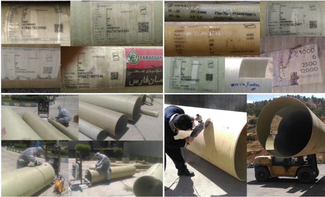
شکل ۶- مشخصات نمونه لوله‌های فایبرگلاس انتخابی با قطرهای ۲۰، ۴۰، ۱۵۰، ۲۰۰، ۲۰۰ B، ۳۰۰، ۳۰۰ B، ۶۰۰، ۸۰۰، ۸۰۰ B و لوله ۱۰۰۰ میلی‌متر جدید و قدیمی جهت ارزیابی زبری سطح داخلی لوله
