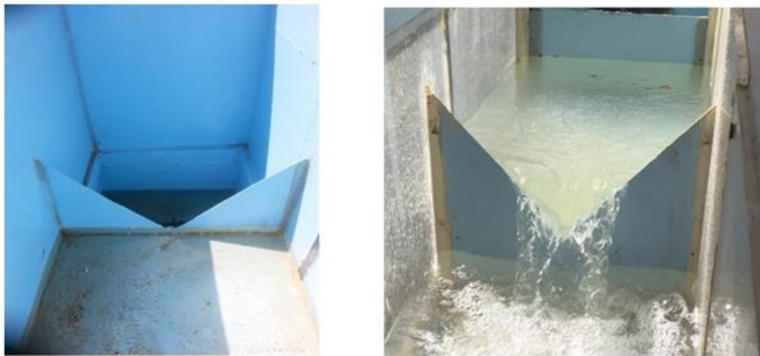
شکل ۲- سرریزهای ورودی و خروجی مثلثی با رأس ۹۰ درجه، در ابتدا و انتهای فلوم
