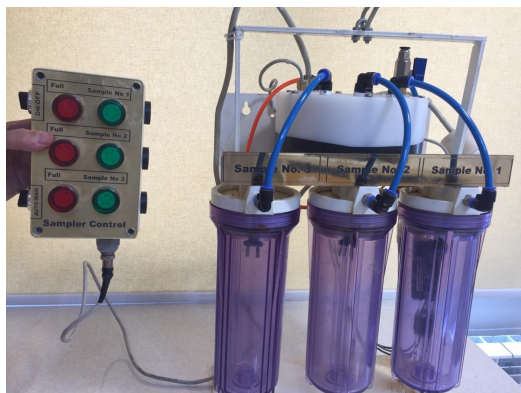
شکل ۲- دستگاه نمونه بردار اتوماتیک طراحی و ساخته شده در شرکت آبفای استان قم
