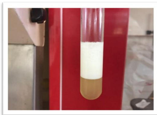
شکل ۴- سنجش ظرفیت امولسیون کنندگی نفت خام و گازوئیل
