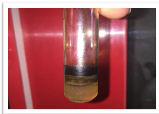
شکل ۴- سنجش ظرفیت امولسیون کنندگی نفت خام و گازوئیل
