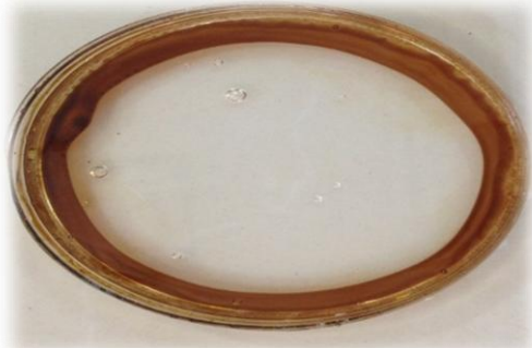
شکل ۳- گسترش نفت خام توسط سوپرناتانت کشت ۹ روزه باکتری
