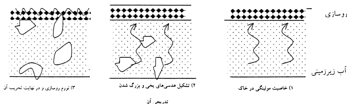
شکل ۱- مراحل تورم روسازی در نتیجه آب‌های زیرزمینی و یخبندان (حبیبی نوخندان، ۱۳۸۳)
