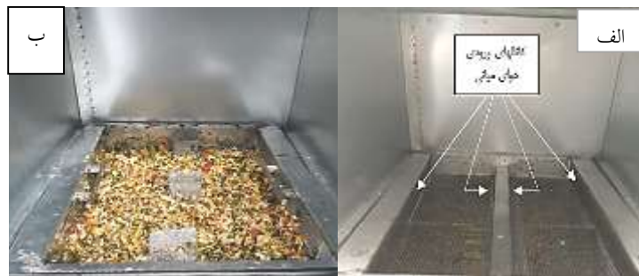
شکل ۱- روش های آزمایش الف: الگوی سینی معمولی ب: الگوی هواگذر جانبی و میانی
