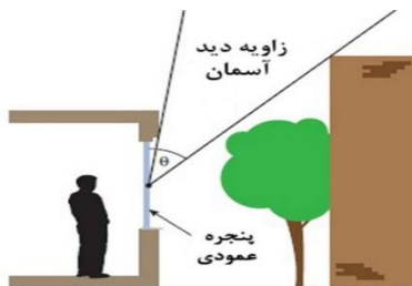
شکل ۴: روش اندازه‌گیری زاویه دید آسمان در مقطع (CIBSE, 1999, 25).
