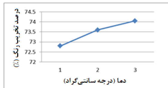
شکل ۱۳- اثر دماهای مختلف بر حذف اریتروزین با \text{pH} = 4 و 25^\circ\text{C} درجه سانتی‌گراد، سرعت هم زدن ۱۸۰ دور در دقیقه و غلظت اولیه رنگ ۸ میلی‌گرم / لیتر در ۱۵۰ میلی‌لیتر محلول رنگ.
