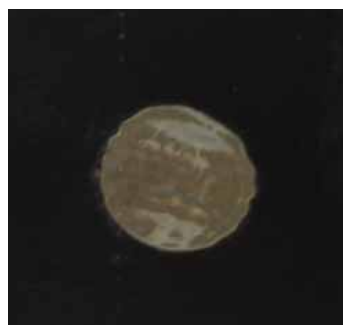
شکل ۱۱: اثر پالس لیزر Ce:Nd:YAG آنیل شده در محیط هوا با انرژی حاصل E=516 \text{ mJ}
