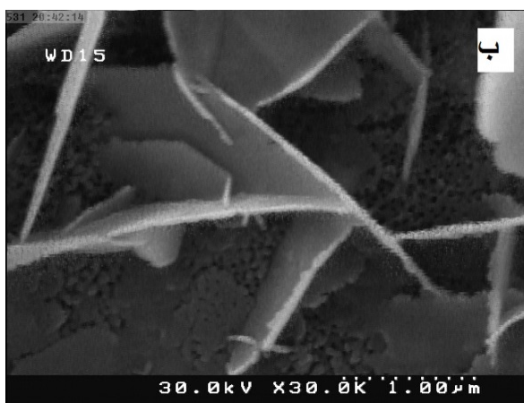
شکل ۳. نانوصفحات نقره تولید شده با ضخامت‌های متفاوت الف) ۱۰۰ نانومتر و ب) ۵۰ نانومتر تولید شده بر روی نانولوله‌های دی‌اکسید تیتانیوم
