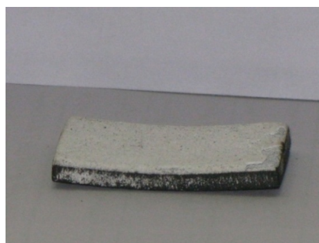
شکل ۴: تصویر نمونه پس از آزمون شوک حرارتی.
