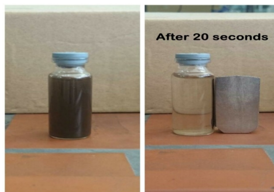
شکل ۴: جداسازی نانوذرات مغناطیسی هسته-پوسته \text{Fe}_3\text{O}_4@\text{MnO}_2 از محلول آبی با کمک آهنربا.
