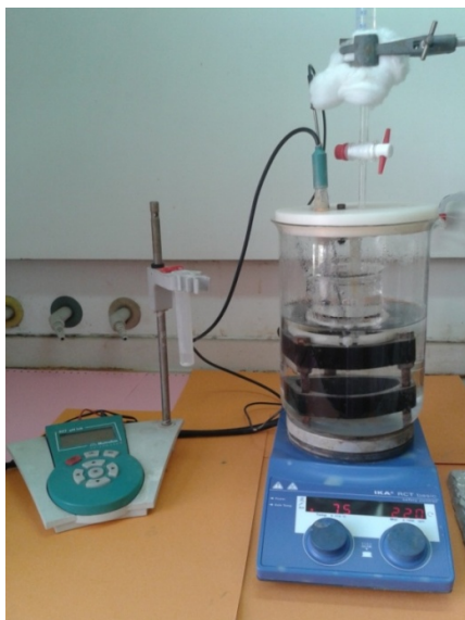
شکل ۱: سازوکار روش CBD برای لایه نشانی.
