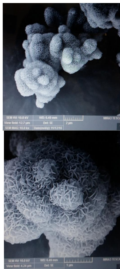
شکل ۴: تصویری از توپوگرافی سطح مواد (SEM) نانوذرات مولیبدن سولفید پوشش دار با پلی اتیلن گلیکول.
