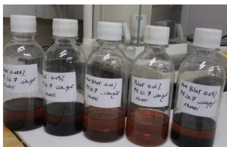
شکل ۵: نمونه‌های نانو روغن با درصد‌های متفاوت پوشش دار و بدون پوشش.
