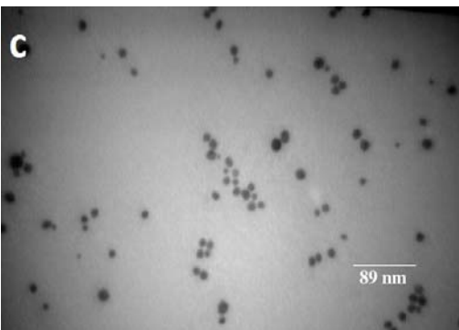
شکل ۳: (a) تصویر TEM نانوذرات نقره در آب، (b) تصویر TEM نانوذرات نقره در اتانول و (c) تصویر TEM نانوذرات نقره در اتیلن گلیکول.
