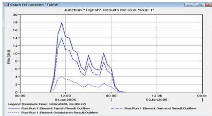
شکل ۴- هیدروگراف خروجی حوزه آبخیز گلاب‌دره- دربند، مدل‌سازی شده با استفاده از نرم‌افزار HEC-HMS برای بارش حداکثر ۲۴ ساعته با دوره برگشت ۱۰ ساله برای دوره ۸۳-۱۳۸۲ تا ۹۵-۱۳۹۴ (۶،۵۸ میلی‌متر).
