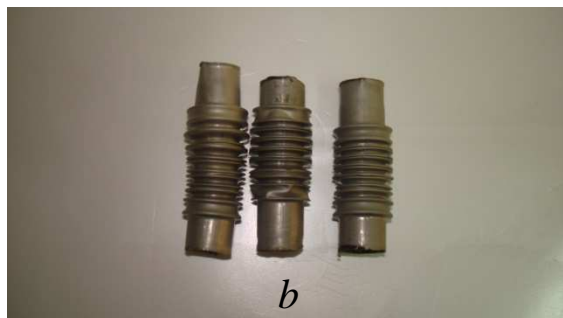
شکل (۳): (a) نمونه بیلوزهای تولید شده سالم در فشار 100 bar (b) نمونه بیلوزهای چروک شده در فشار 75 bar
