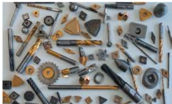
شکل (۳): برخی از قطعات هاردمتال که پوشش‌دهی نیز شده‌اند [۱۹].
