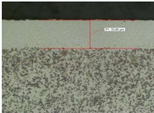
شکل (۱۱): ریزساختار کاربید سمانته گراذیانی تهیه شده از پودر W-Ti-C-N-Co (تف‌جوشی شده در دمای ۱۴۵۰ درجه سانتی‌گراد) با سطح عاری از فاز گاما. ضخامت لایه گراذیانی سطحی حدود ۳۴ میکرون است [۱۰۴].
