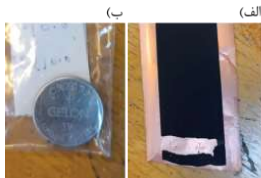
شکل (۲): تصویر الف) الکترو د پوشش داده شده و سل ساخته شده و ب) سل ساخته شده.
