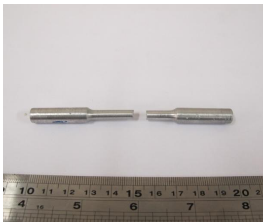
شکل (۲): نمونه‌ای از قطعه کامپوزیتی پس از عملیات آزمون کشش.
