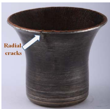
شکل (۱۵): قطعه دولایه تولید شده با نسبت اسپینینگ ۲.۶
