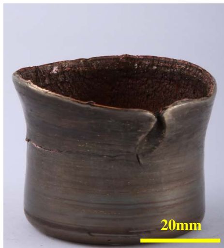
شکل (۱۳): قطعه دو لایه تولید شده با نسبت اسپینینگ ۲/۲، مسیر حرکتی ابزار از نوع خطی
