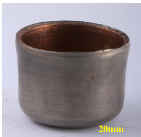
شکل (۱۲): قطعه دولایه تولید شده با نسبت اسپینینگ ۲/۲، مسیر حرکتی ابزار از نوع اینولوت
