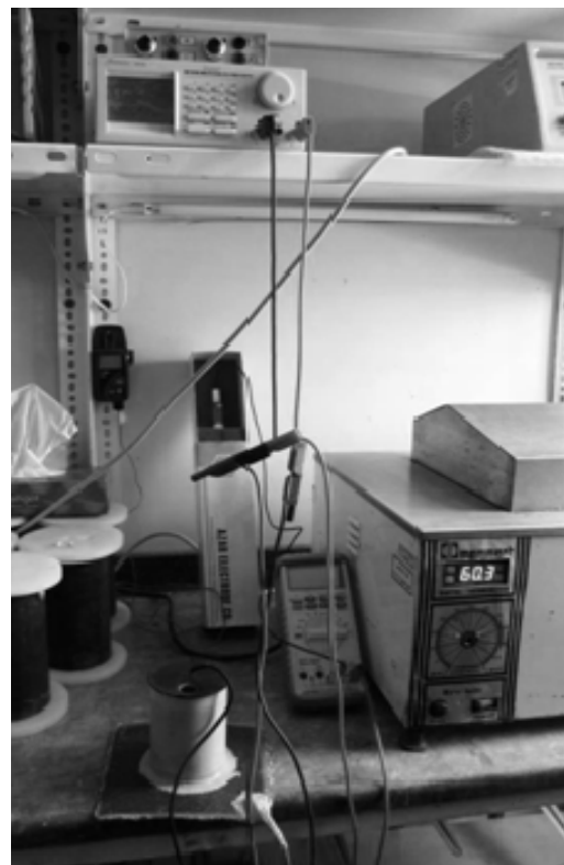
شکل (۵): نحوه انجام آزمایش جدایش کاتدی ۲ روزه در دمای 20 \pm 60^\circ\text{C}
