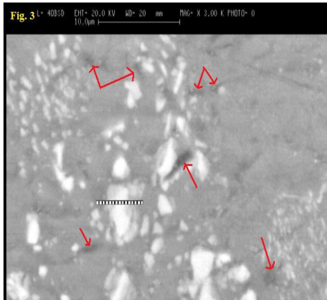
شکل (۳): تصویر SEM از نمونه ریختگی به همراه آنالیز EDAX خطی از یک ذره تقویت کننده (فلش‌ها نشان دهنده تخلخل‌های ریخته‌گری است).
