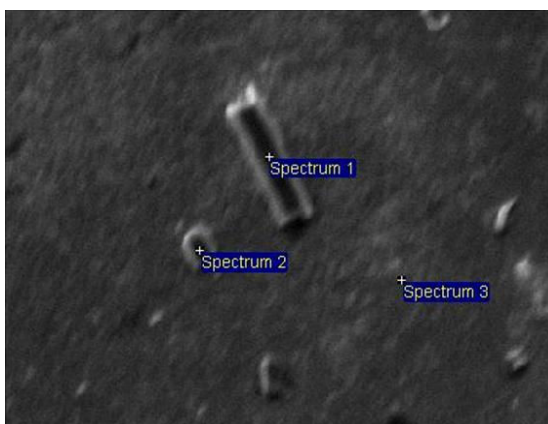
شکل (۶): تصویر میکروسکوپ الکترونی نمونه نگهداری شده در دمای ۷۵۰ درجه به مدت ۲۰ ساعت و کوئنچ شده
