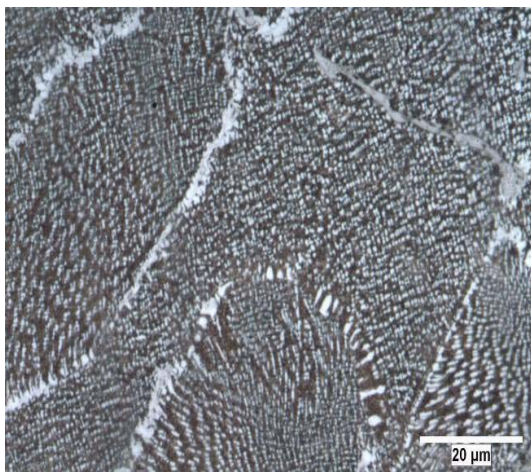
شکل (۶): یوتکتیک‌های \gamma-\gamma' حاصل از انجماد در بزرگنمایی بیشتر.
