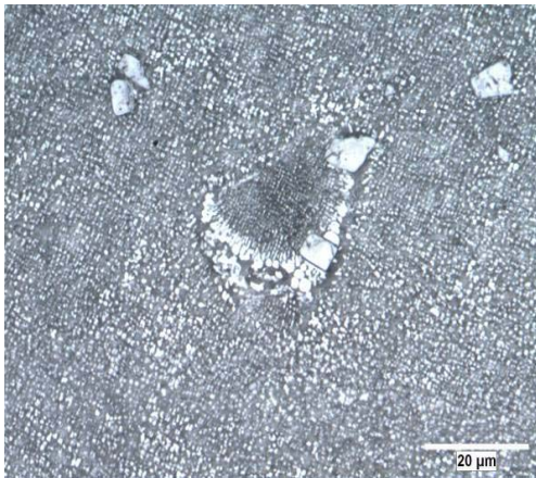
شکل (۵): تصویر میکروسکوپ نوری از ریزساختار ریختگی، یوتکتیک‌های \gamma-\gamma' مشاهده می‌گردند.
