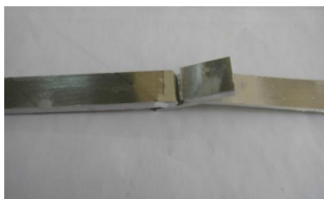
شکل (۱۶): محل شکست در نمونه جوشکاری شده با ۹۰۰ rpm
