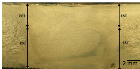
شکل (۱۳): ضخامت مؤثر ورق (EST) در دو ورق برای نمونه ۹۰۰ rpm
