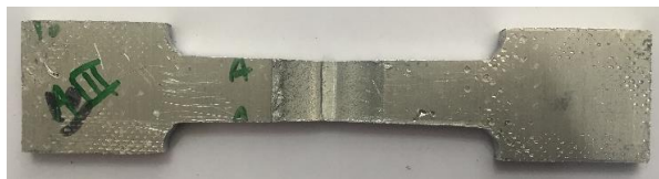
شکل (۴): تصویر محل شکست در نمونه شماره ۹
