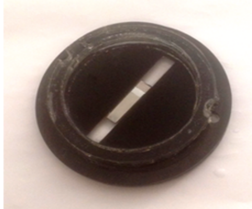
شکل (۱): نگهدارنده استفاده شده برای انجام زمون سایش در محلول رینگر، بر روی نمونه های پوشش داده شده
