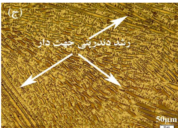
شکل ۳: ریز ساختار حاصل از فلز پرکننده اینکونل ۶۲۵: (الف): مرکز جوش، (ب): ریشه جوش و (ج): کناره جوش
