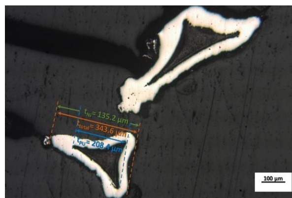
شکل (۱): نحوه‌ی اندازه‌گیری ضخامت استرات در فوم پلی اورتان و فوم نیکل
