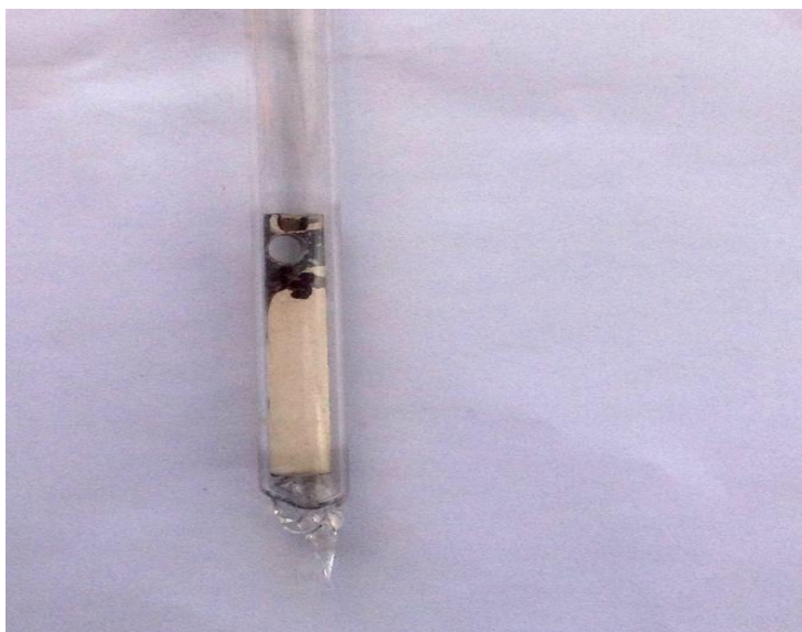
شکل (۱): نمونه ای از پوشش خام که در شرایط خلاء درون لوله شیشه ای از جنس کوآرتز کپسوله شده است
