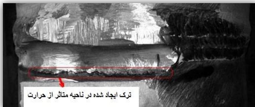
شکل (۱): ترک ایجاد شده در ناحیه متأثر از حرارت جوشکاری نمونه آئیل نشده
