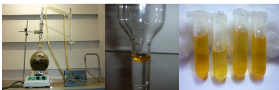
تصویر ۱- شمایی از دستگاه کلونجر و اسانس استخراج شده از گیاه آویشن کوهی
