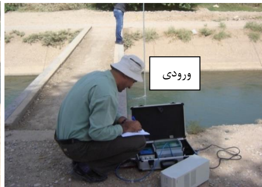
شکل ۱- اندازه‌گیری سرعت در ورودی و خروجی اصلی کانال E4
