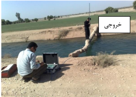
شکل ۱- اندازه‌گیری سرعت در ورودی و خروجی اصلی کانال E4
