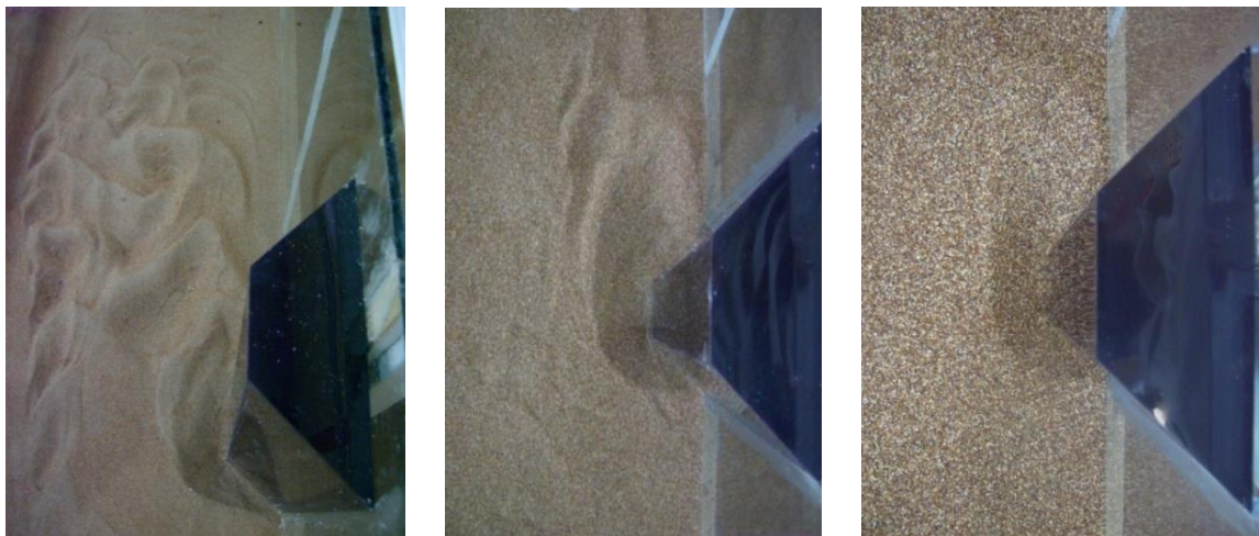
شکل ۹. فرم بستر در تکیه گاه دوزنقه برای بستر با اندازه ذرات ۰/۳۵، ۰/۲، ۱/۵ میلی متر (از چپ به راست)
