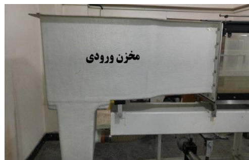
شکل 1- مخزن ورودی و صفحه آرام کننده تلاطم جریان ورودی کانال
