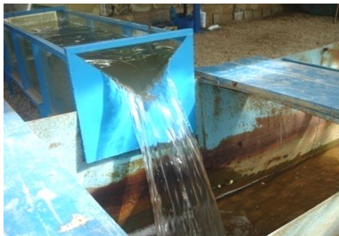
شکل ۲- سرریز ۹۰ درجه اندازه‌گیری دبی خروجی از لوله گردابی
