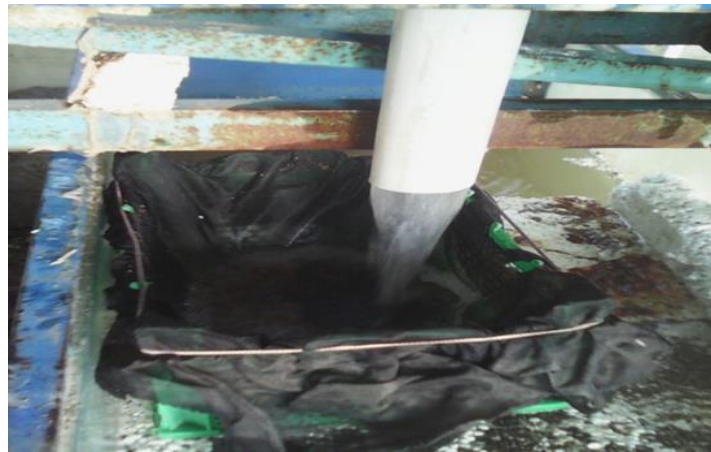
شکل ۳- لوله خروجی دبی و رسوب انحرافی و جمع آوری رسوب
