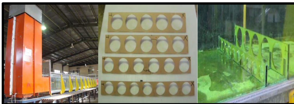
شکل ۱ - نمایی از فلوم آزمایشگاهی و دیواره های بکار رفته (خانخانی و همکاران، ۱۳۹۵)
