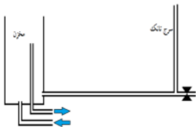
شکل 1 شماتیک دستگاه تست ضربه قوچ
