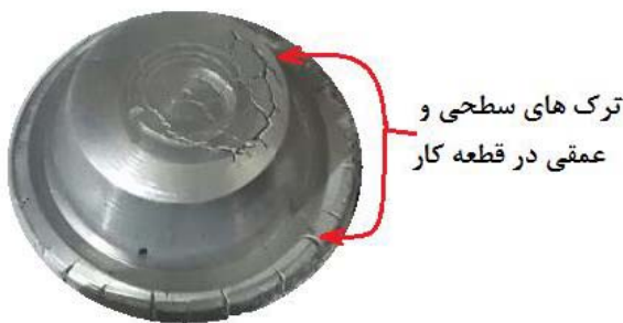
شکل ۱۱ عیوب سطحی و داخلی ایجاد شده در اثر لغزش قطعه‌کار در حین فرایند فورجینگ
