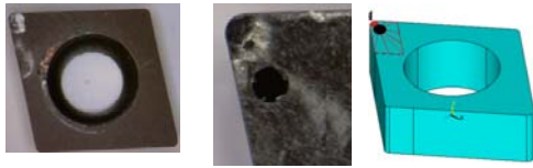
شکل ۲ نمایش ترموکوپل جایگذاری شده در ابزار برش.
