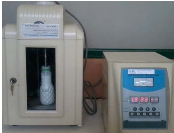
شکل ۵ آماده سازی نانوسیال با همزن التراسونیک.
