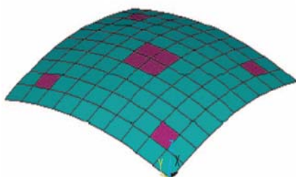
شکل ۲۲: مکان‌های بهینه‌یافته شده در اثر مش‌بندی و قرار یافتن حسگر و عملگر پیزوالکتریک بر روی پنل
