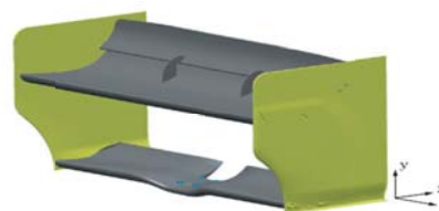
شکل ۱۸: بال پشتی یک ماشین مسابقه‌ای
