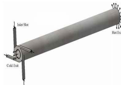
شکل ۲: مدل سازی سه بعدی لوله گردبادی در مقیاس میکرو
