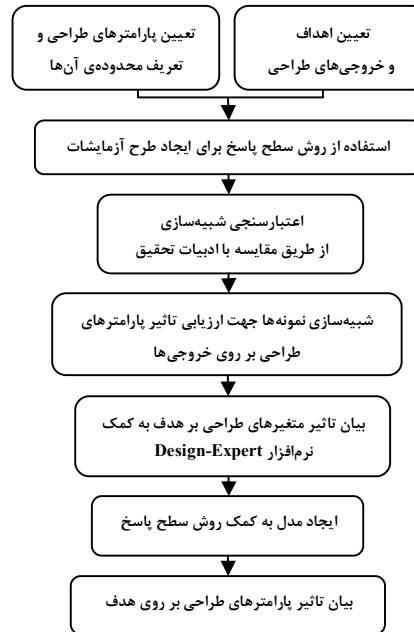
شکل ۲ گام‌های در نظر گرفته شده جهت بررسی لوله‌های استوانه‌ای جدار نازک شیاردار
