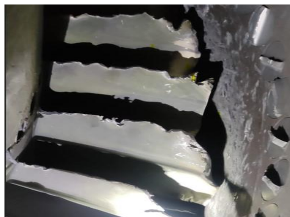
شکل ۱ تصویری از خرابی توربین در نیروگاه گازی کرکوک واقع در عراق
