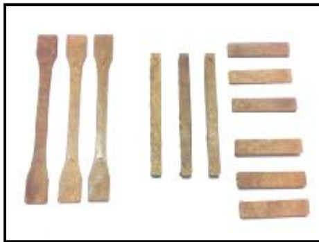
شکل 1- نمونه‌های ساخته شده برای انجام آزمون‌های مکانیکی
