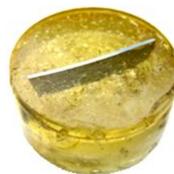
شکل (6) حالت قرارگیری تکه‌های نمونه در مانت شفاف.
