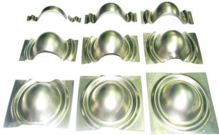
شکل (3) نمونه‌های تغییر شکل یافته پس از انجام آزمایش اریکسن.
